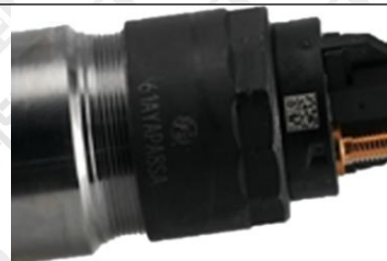
letras de carcasa de inyector y código QR
